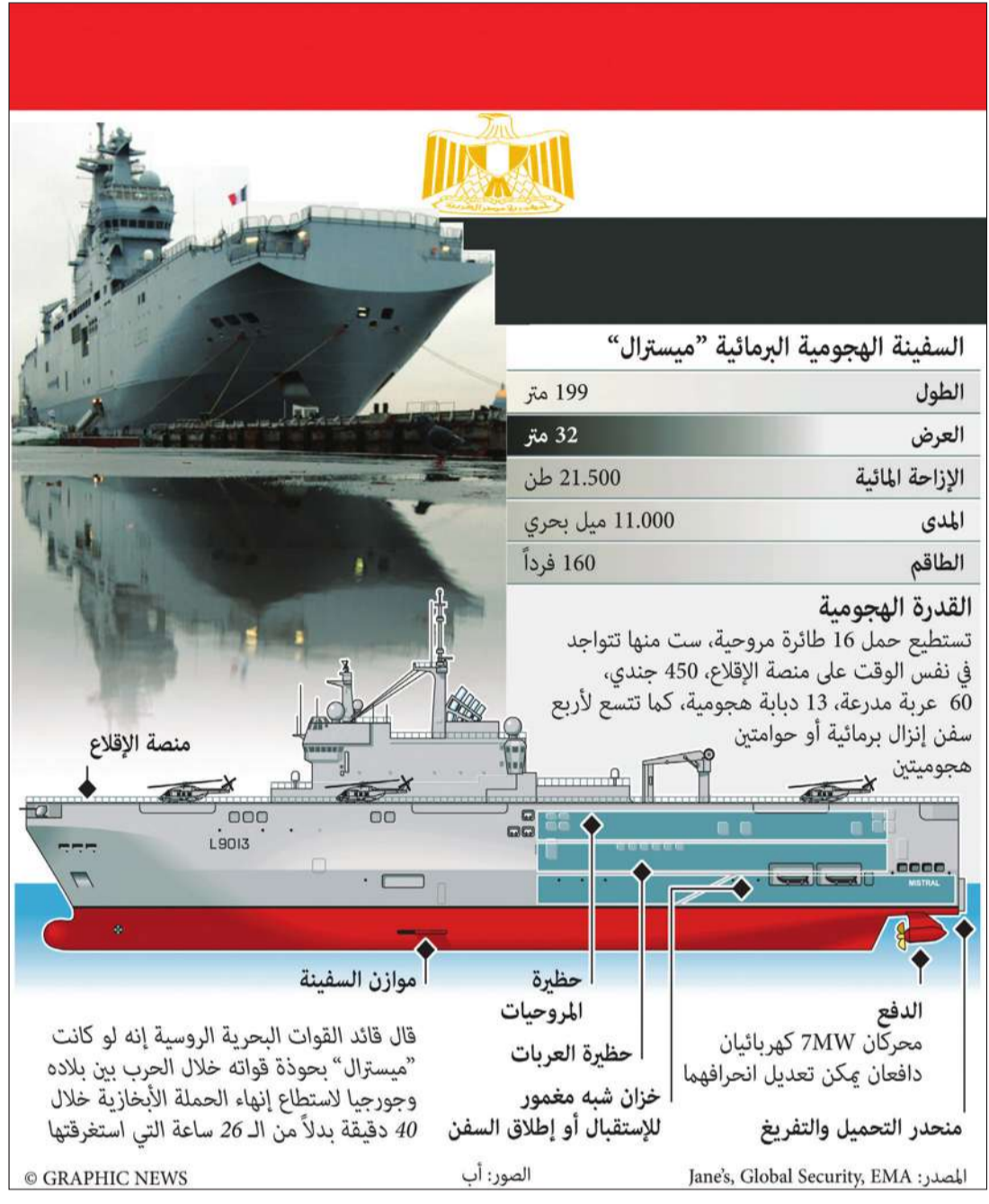
السفينة الهجومية البرمائية «ميسترال» الطول 199 متر العرض 32 متر الإزاحة المائية 21.500 طن المدى 11.000 ميل بحري الطاقم 160 فرداً القدرة الهجومية تستطيع حمل 16 طائرة مروحية، ست منها تتواجد في نفس الوقت على منصة الإقلاع، 450 جندي، 60 عربة مدرعة، 13 دبابة هجومية، كما تتسع لأربع سفن إنزال برمائية أو حوامتين هجوميتين
