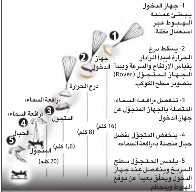
1- جهاز الدخول يبطئ عملية الهبوط عبر استعمال مظلة. 2- يسقط درع الحرارة فيبدأ الرادار بقياس الارتفاع والسرعة ويبدأ الجهاز المتجول (Rover) بتصوير سطح الكوكب. 3- تنفصل «رافعة السماء» المتصلة بالجهاز المتجول عن جهاز الدخول. 4- ينخفض المتجول بفضل حبال متصلة ب«رافعة السماء». 5- يلمس المتجول سطح المريخ وينفصل عنه جهاز الدخول ويطلق بعيداً عن موقع الهبوط ويتحطم.
