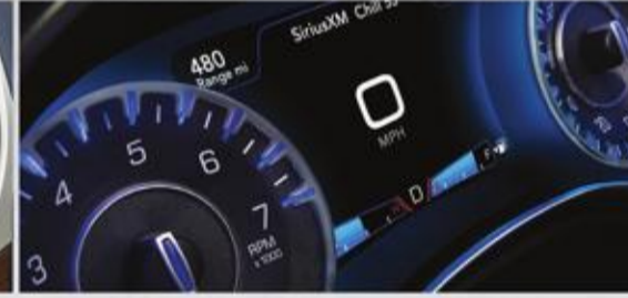
لوحة عدادات بتقنية شرائح الترانزستور الرقيقة قياس 7 بوصة
