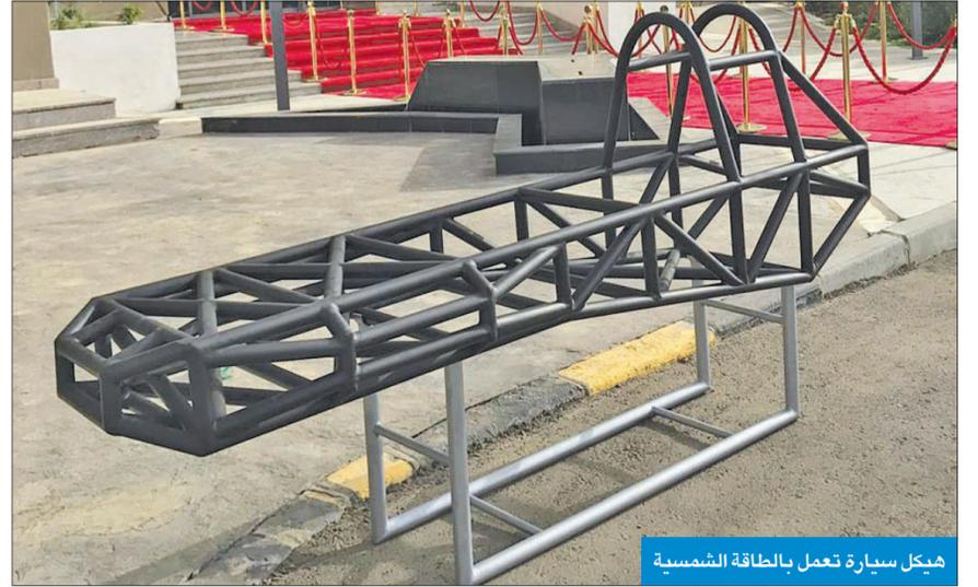
هيكل سيارة تعمل بالطاقة الشمسية
