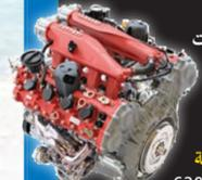
النوع: محرك ذو 8 أسطوانات (V8) - مثبت بزواوية 90 درجة - توربو مزدوج - القطر ومدى الحركة: 82x86.5 ملم - الحد الأقصى من الطاقة الناتجة: 456 كيلو واط (620 حصاناً) عند 7500-5750 دورة في الدقيقة - عزم الدوران الأقصى: 760 نيوتن/متر عند 3000 ÷ 5750 دورة في الدقيقة
