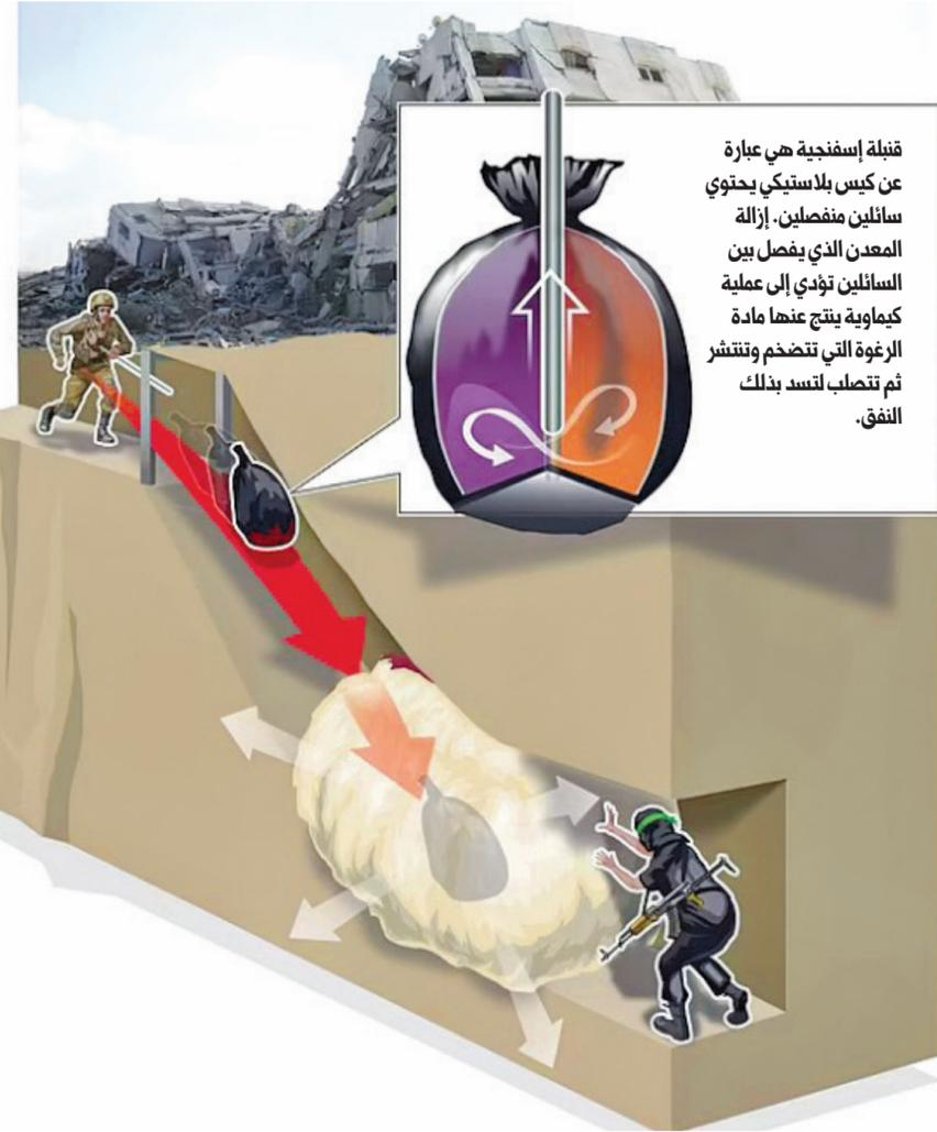
قنبلة إسفنجية هي عبارة عن كيس بلاستيكي يحتوي سائلين منفصلين. إزالة المعدن الذي يفصل بين السائلين تؤدي إلى عملية كيميائية ينتج عنها مادة الرغوة التي تتضخم وتتفجر ثم تتصلب لتسد بذلك النفق.
